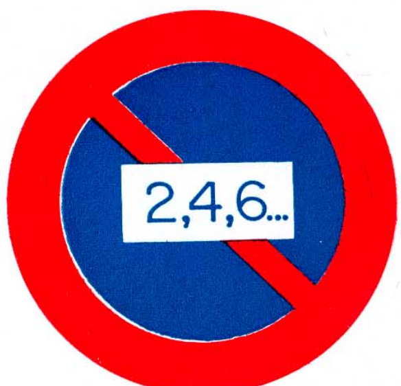
Figura 4.—Señal que proponemos para indicar la prohibición de estacionar los días pares en el lado de la calzada donde esté esta señal. Los días pares se podrá, por consiguiente, estacionar al otro lado.
