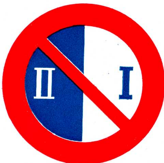
Figura 1.—Señal B-236. Estacionamiento alternativamente prohibido. Prohibición de estacionar los días pares en el lado de la vía correspondiente al símbolo II y los impares en el correspondiente al I.
