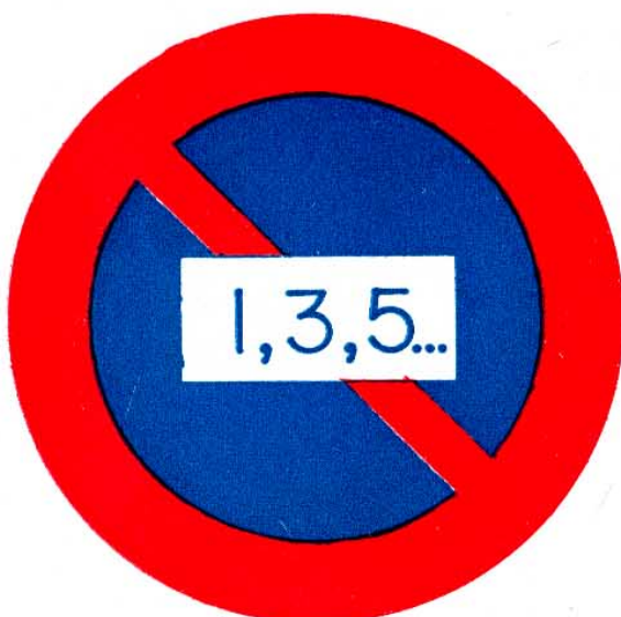
Figura 3.—Señal que proponemos para indicar prohibición de estacionar los días impares en el lado de la calzada donde esté esta señal. Los días impares se podrá, por consiguiente, estacionar al otro lado.
