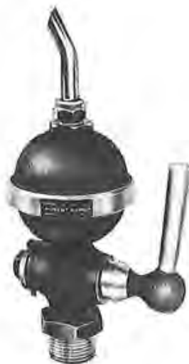
Figura 2. Ventosa trifuncional Ramus, tipo Thorens. Patentada. De 1 y de 1,25 pulgadas. Para presiones hasta de 12 atmósferas. Inoxidable (en bronce).
