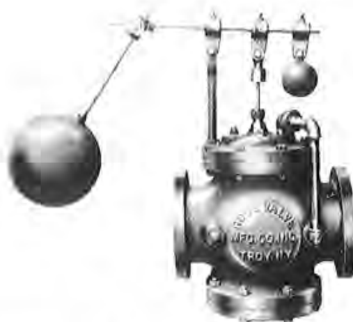
Figura 3.— Válvula de alta seguridad (tipo globo) para llenado de depósitos de agua. No necesita energía eléctrica, está equilibrada hidráulicamente para no producir tensiones internas, y se cierra lentamente sin producir sobrepresiones.
