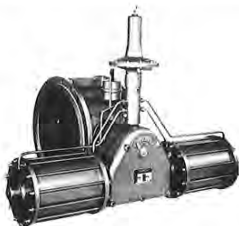
Figura 2.— Válvula de mariposa de accionamiento hidráulico, no eléctrico. Tiene la ventaja de no necesitar energía externa para su funcionamiento y las desventajas de no ser una válvula equilibrada hidráulicamente.
