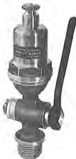
Figura 1. Ventosa trifuncional Ramus, tipo Vanoise. Patentada. De 3/4 de pulgada. Para presiones hasta de 8 atmósferas. Inoxidable (en bronce).
