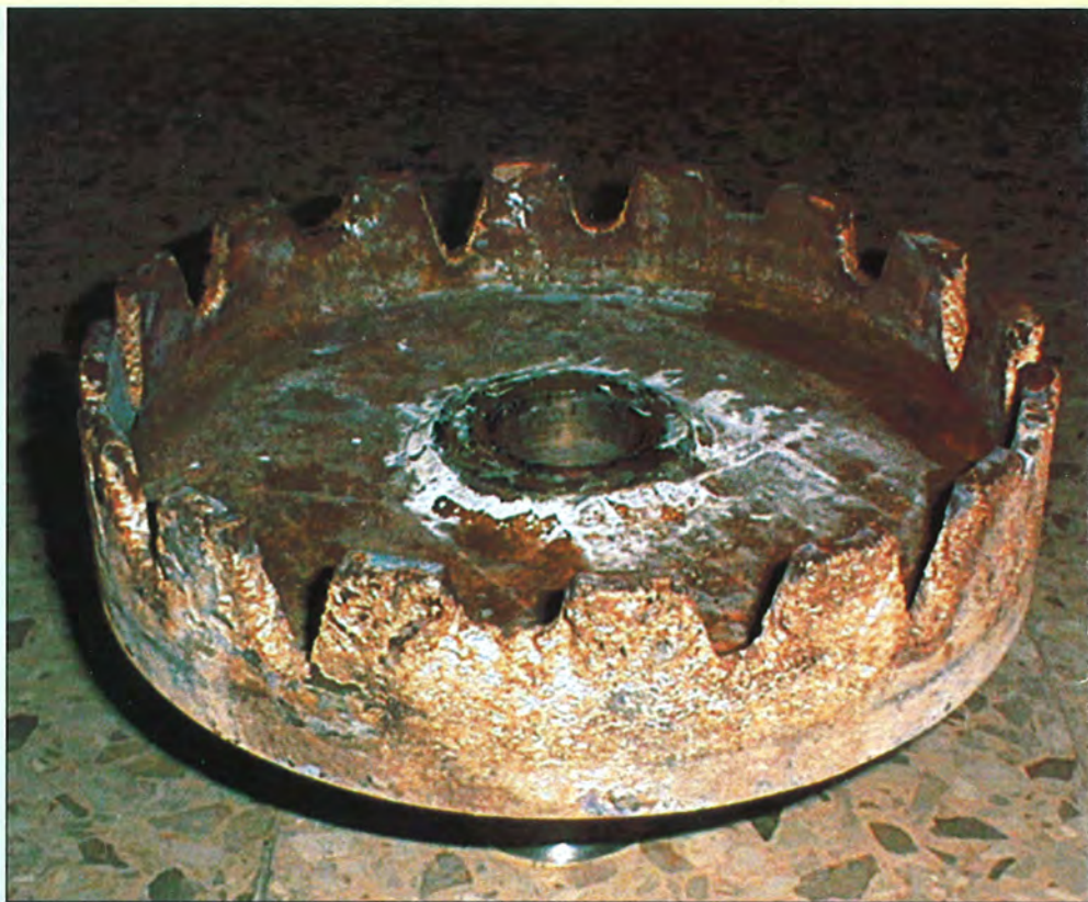
Corona de una válvula que ha sufrido de la cavitación.
