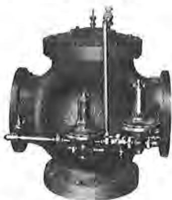
Válvula Ross-Mateos, reductora y contra inundaciones. Se cierra al haber una rotura agua abajo.
