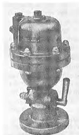
Figura 3.—Ventosa semi-trifuncional Ramus, purgador sónico hasta 20 atm. Con válvula de cierre incorporada, y aperturas para purgadores de acción manual.
