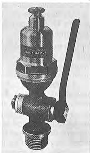
Figura 1.—Ventosa trifuncional Ramus para presiones de trabajo hasta 8 atm. En bronce. Con válvula de cierre incorporada.
