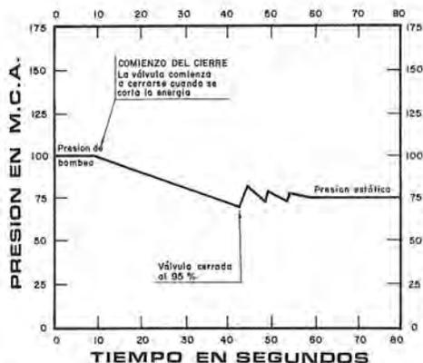
Figura 3.—Representación teórica de las hidropulsaciones residuales en un sistema de bombeo optimizado.
