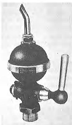
Figura 2.—Ventosa trifuncional Ramus para presiones de trabajo hasta 12 atm. En bronce. Con válvula de cierre incorporada y posición de esta como purgador manual.
