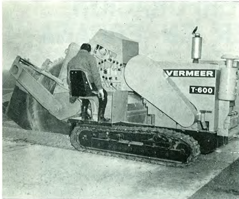
Zanjadora con disco-sierra de la casa Vermeer Manufacturing Co.
