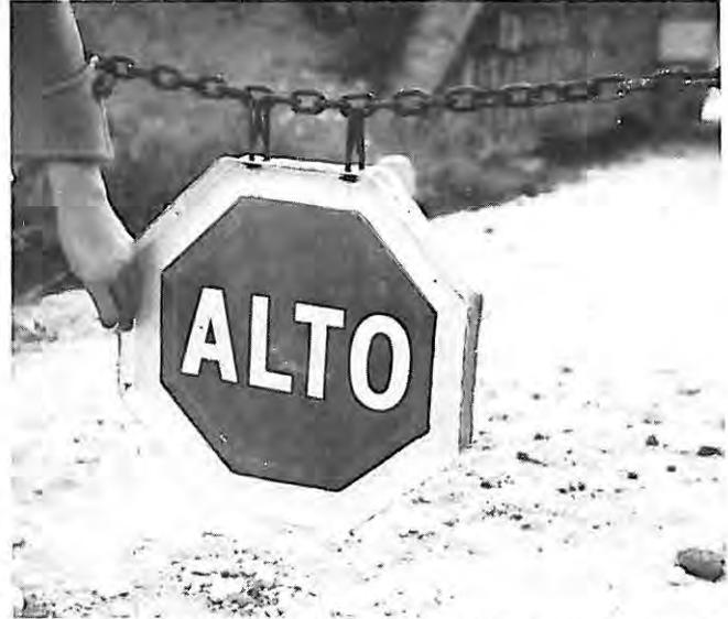
Foto 5.—Nueva señal después de varios meses en uso sin ser apenas afectada por las perdigonadas, pedradas o roce al abrir la portillera.
