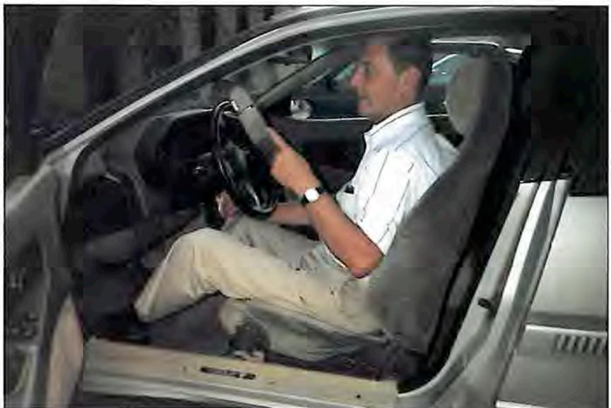
*La bandolera del cinturón de seguridad de este coche se coloca automáticamente, aunque el conductor no quiera. Al abrir la puerta se desplaza ella sola hasta la posición que se indica en la foto. La correa que sujeta la cintura se coloca manualmente si así se desea.*
