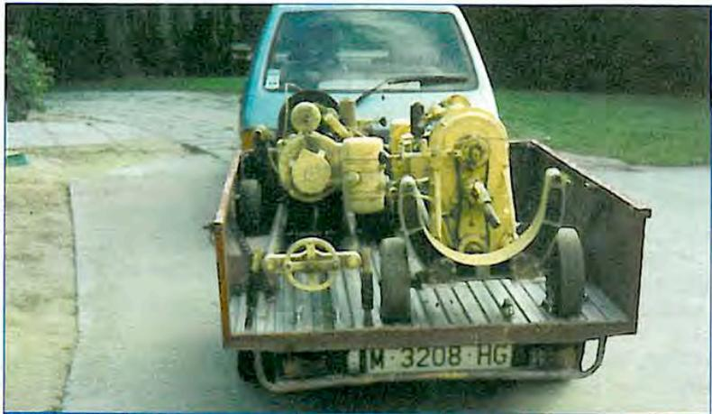
Remolque que hice para transportar dos máquinas para hacer sondeos.
