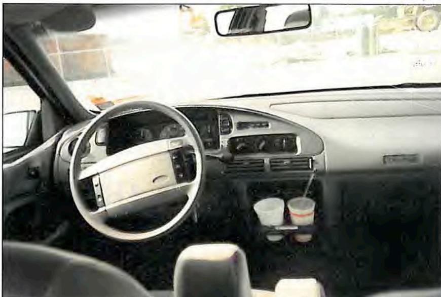
En este coche de precio moderado que no se vende en España podemos ver varios detalles como la **bolsa de aire**, **claxon en el centro del volante**, **controlador de la velocidad (cruise control)**, y **sistema de emergencia detrás del volante**, muy visible. También tiene una bandeja que se puede sacar para poner dos vasos.
