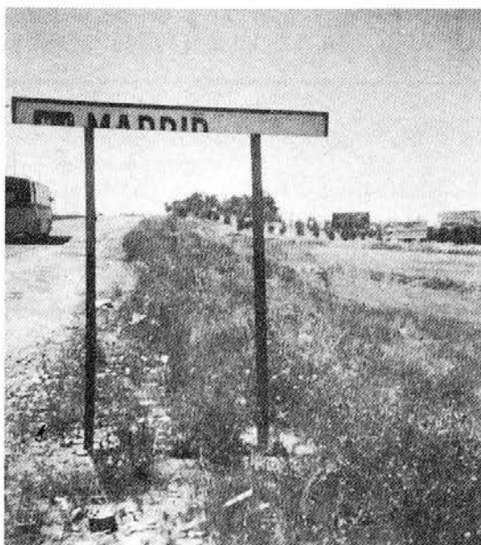
Fotografía 1. Centenares de carteles de aluminio han sido desmantelados para vender el material como chatarra. Esto no ocurre con los de vitro-resina (PRFV).
