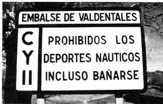
Señal-cartel hecha con fibras de vidrio embebidas en resina poliéster. Colocada en zona de nieblas. No muestra oxidación alguna después de diez años de estar colocada.
